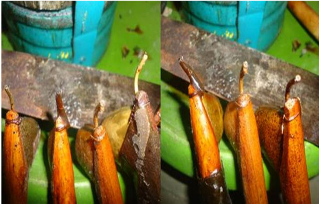
Gambar 1.1 Gambar canting konvensional dan lubang canting yang tersumbat.
